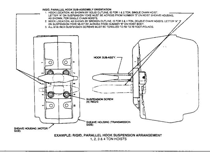
FIGURE 5-3. TOP SUSPENSION ORIENTATION
