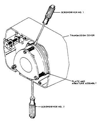
FIGURE 4-3. LOAD BRAKE FUNCTION CHECK
